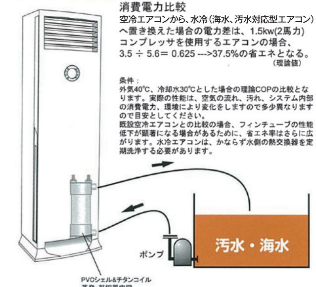
水スケール/海水汚れ対策に循環洗浄でメンテナンスが可能です
