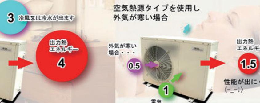
ヒートポンプは、「1」のエネルギーを使って「2」「3」「4」の熱を吸収し、合わせて「3」「4」の熱エネルギーを取り出すことができます。
